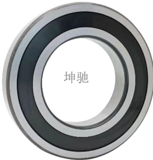
深沟球轴承适用于高转速甚至极高转速的运行，而且非常耐用，无需经常维护。该类轴承摩擦系数小，极限转速高，尺寸范围与形式变化多样，应用在精密仪表、低噪音电机、汽车、摩托车及一般机械等行业，是机械工业中使用\*\*为\*\*\*的一类轴承。主要承受径向负荷，也可承受一定量的轴向负荷。深沟球轴承是滚动轴承中\*\*为普通的一种类型。基本型的深沟球轴承由一个外圈，一个内圈、一组钢球和一组保持架构成。深沟球轴承类型有单列和双列两种，深沟球结构还分密封和开式两种结构，开式是指轴承不带密封结构，密封型深沟球分为防尘密封和防油密封。防尘密封盖材料为钢板冲压，只起到简单的防止灰尘进入轴承滚道。防油型为接触式油封，能有效的阻止轴承内的润滑脂外溢。单列深沟球轴承类型代号为6，双列深沟球轴承代号为4。其结构简单，使用方便，是生产\*\*普遍，应用\*\*\*\*\*的一类轴承。
